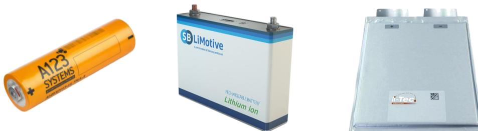
Bild 3.50.: Lithium-Ionen-Zellen: Rundzelle mit  $C_{Nenn} = 4,4Ah$  für HEV Anwendungen (links), Prismatische Zelle mit  $C_{Nenn} = 40Ah$  zum Einsatz im EV (mitte) und Pouch-Zelle mit  $C_{Nenn} = 6,5Ah$ .
