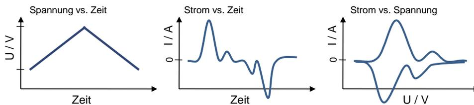
Bild 3.53.: Schematische Darstellung einer CV-Messung.
