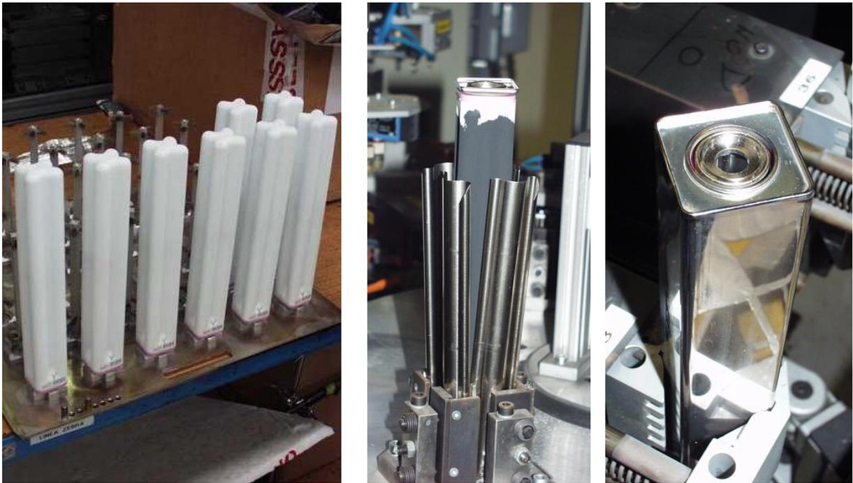
Bild 3.36.: Fertigung der Zebra-Batterie: (von links) Kleeblatt-Elektrolyte, Aufbringen der Kapillarbleche, Zellbecher vor der Befüllung mit NaCl/Ni-Granulat, Quelle: MES-Dea
